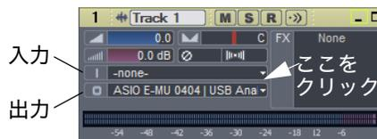
2. "I" フィールド右端の小さな三角形をクリックし、入力ソースを設定します。E-MU 0404 USB 2.0 のアナログ入力 "A" 端子のシグナルをモノラルで録音する場合は、"**Left ASIO E-MU 0404|USB Analog In A**" を選択して下さい。両方の入力端子をステレオシグナルとして録音する場合は、"**Stereo ASIO E-MU 0404|USB Analog In A**" を選択して下さい。
